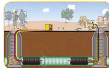
Test d'étanchéité (OMT + OMTB)
